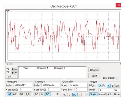
Рис. 36. Осциллограмма сигнала на выходе генератора Noise Source
